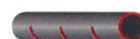
CANALISATIONS RIGIDES Ø 90mm AVEC OUVERTURES Ø 10mm OU FENTES DE 5mm minimum ESPACÉES TOUTS LES 10 A 15cm
